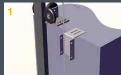
Der Sensor wird mit Hilfe eines Montagewinkels am Fahrkorb befestigt und über ein Kabel mit der Steuerung oder SAFE BOX verbunden.
