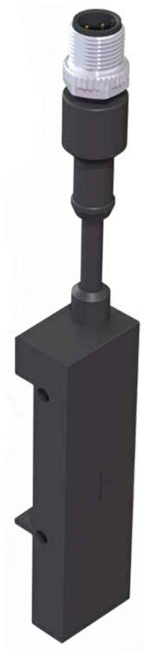
Stockwerksensoren und -magnete werden zur exakten Erkennung der Stockwerkstürzonen eingesetzt. Die Magnete werden an den Stockwerkstürschwellen oder an der Schachtwand, der Stockwerksensor an der Kabine angebracht. Während der Lernfahrt erkennt der Aufzug automatisch die genaue Position und überträgt diese Information an die Aufzugsteuerung. Die manuelle Feineinstellung der Stockwerke kann entfallen.
