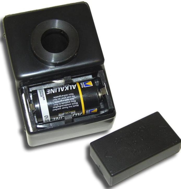
Abbildung 3: HWD15 mit geöffnetem Batteriefach
