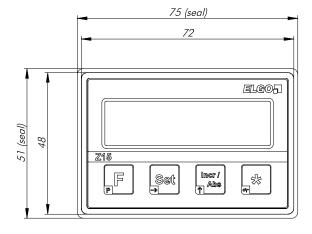
Schalttafelausbruch / Front panel cut-out 68 -0/+0.7 x 45 -0/+0.6 Frontplattendicke / Front panel thickness 1.00, 1.50, 2.00, 2.50 Ohne Dichtung / Without seal 2.50 , 3.00, 3.50
