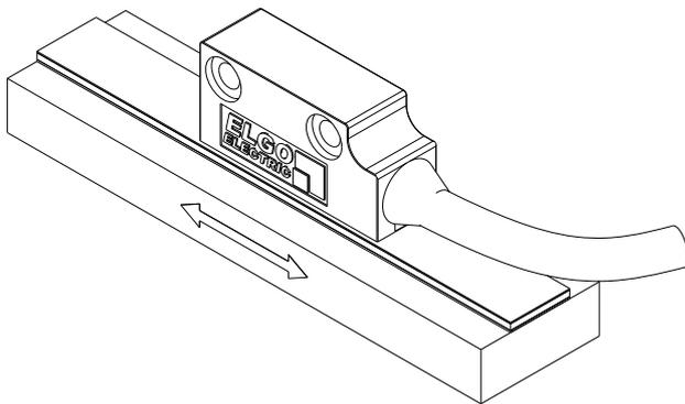
Hierbei wird entlang der zu messenden Wegstrecke das Magnetband auf einen festen Untergrund (z.B. Maschinenbett) aufgeklebt.
