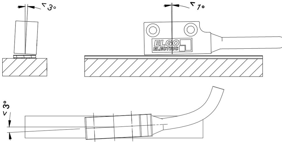
Das Kabel ist so zu verlegen, dass keine Beschädigungsgefahr z.B. durch Zug oder Quetschungen besteht. Bei Bedarf eine Schleppkette oder einen Schutzschlauch verwenden und eine Zugentlastung vorsehen.
