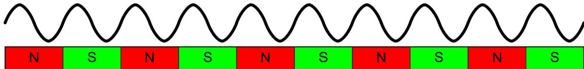
Diese Signale werden dann elektronisch interpoliert, die Auflösung des Messsystems ergibt sich dabei aus der Interpolationsrate und dem Polabstand.
