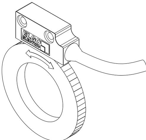
Hierbei wird ein Polring/Polrad auf eine drehbare Achse (z.B. Motorwelle) montiert.
