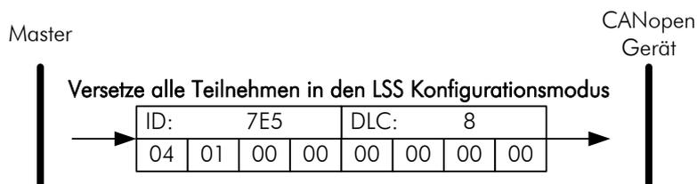
Abbildung 25: Wechseln in den LSS Konfigurationsmodus
