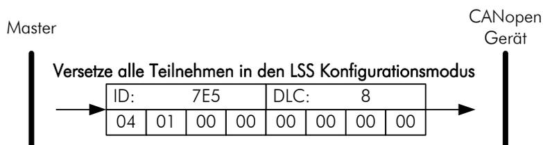
Abbildung 25: Wechseln in den LSS Konfigurationsmodus
