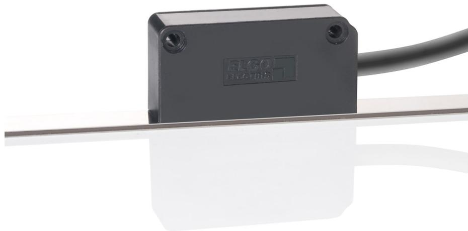
Die Serie IMAX ist ein pseudo-absolutes magnetisches Längenmesssystem. Pseudo-absolut bedeutet hier, dass der Absolut-Code durch einen einmaligen Bewegungsvorgang nach dem Einschalten eingelesen werden muss und das Gerät ab diesem Zeitpunkt absolut-messend arbeitet. So ist es möglich mit einer Sensorkopflänge von nur 50 mm die Absolut-Messung auf der Gesamtlänge von 1000 m zu gewährleisten.
