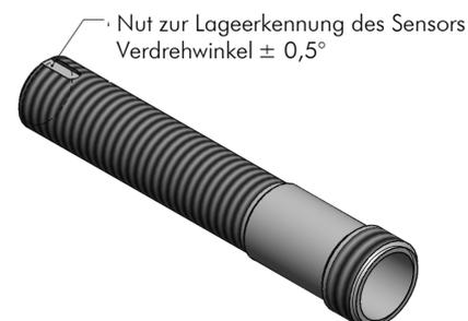
Die Nut muss bei der Installation in die Mitte des Magnetbands positioniert werden.
