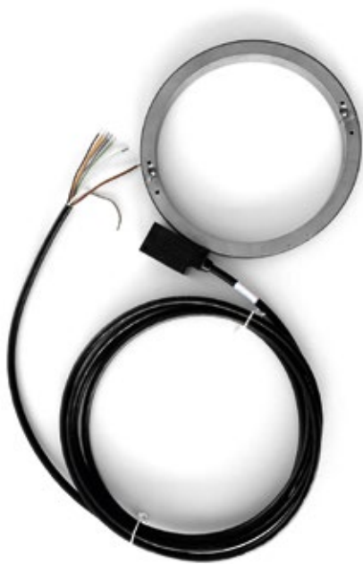
Polring und Magnetsensor zur Geschwindigkeitsüberwachung der Hauptachse einer Fahrtreppe, zweitgeteilter Ring einfaches Retrofit.
